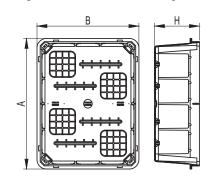
• декоративное оформление и защита мест соединения силовых и информационных кабелей; предназначена для скрытой установки в негорючих основаниях.
